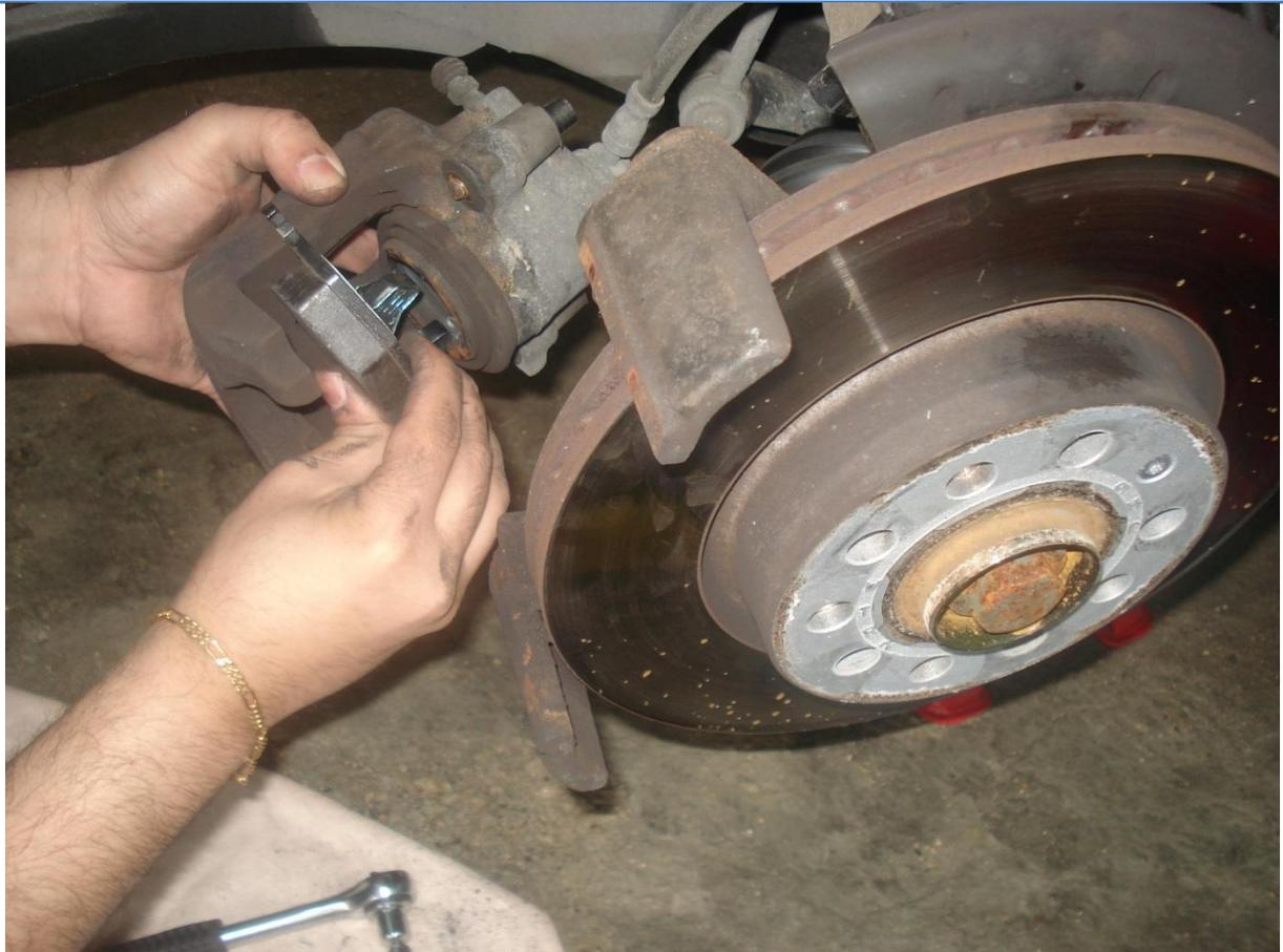
**17. On commence par clipser la nouvelle plaquette (celle avec le connecteur du signal d'usure) dans le piston. (faire toujours attention a ne pas percer le soufflet du piston)**
