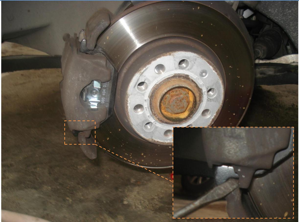
20. Une fois les deux plaquettes clipsées, reposé le bloc de freinage
