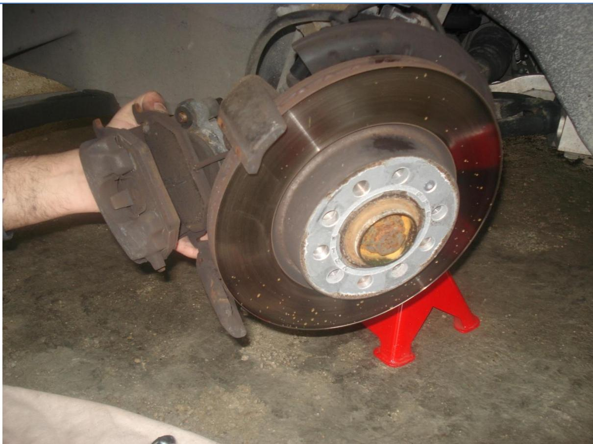
**15. Une fois les deux vis libérées, retirer l'étrier de freinage du disque. (On voit clairement les deux plaquettes de freins libérées)**
