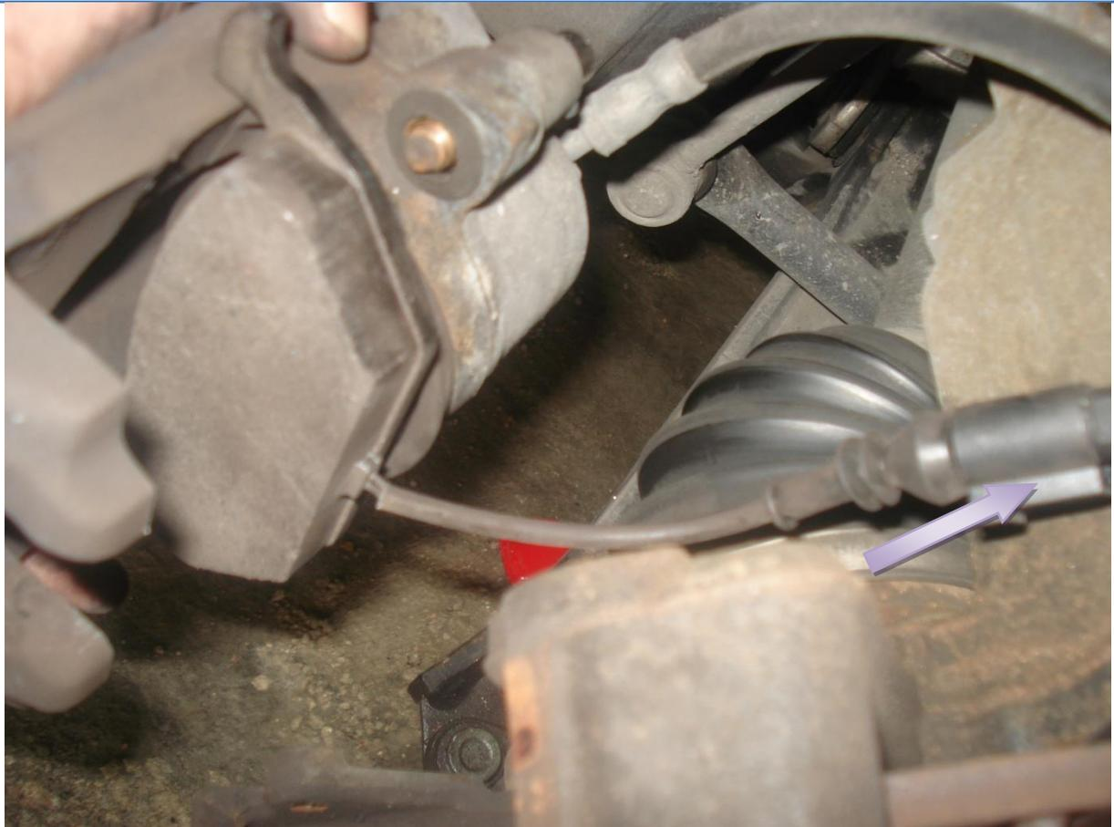
18. Reconnecter le connecteur du signal d'usure de la plaquette. *(voir la flèche violette)*
