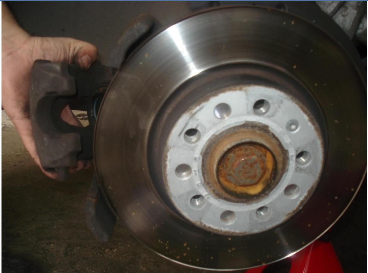
16. Il faut maintenant retirer les deux plaquettes de frein de l'étrier pour les remplacer. Ces plaquettes sont clipsées sur le bloc. Il suffit alors de les déclipser d'un côté du bloc et de l'autre du piston. *(Toujours en faisant attention au soufflet du piston)*
